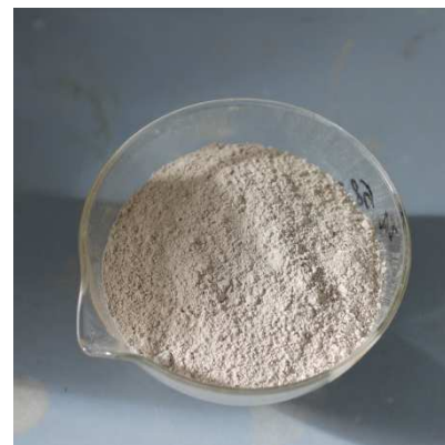
Zinnwaldite (mica) grinded <math><45 \mu\text{m}</math>
